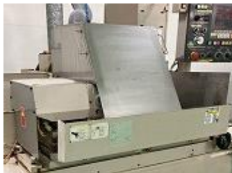
加工機の回転部の露出を 最小限にし、さらに装置外側に ガードを設置 (刈谷事業所)
