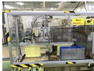
加工機にインターロック付き カバーを設置 (クアーズテック長崎)
